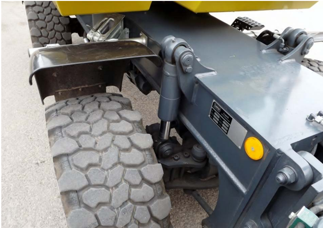
Lanz 3000 Kommunalbagger mit Hydraulischer Federung und Achsenfeststellung .
