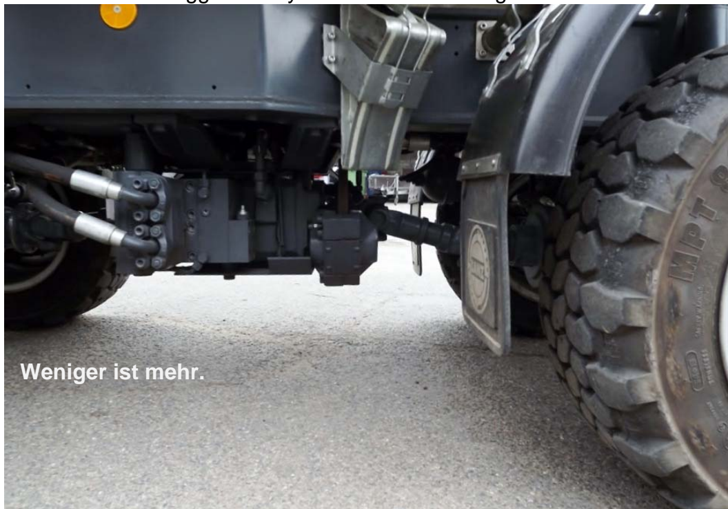
Linde PTO Fahrmotor die kompakte Antriebslösungen ohne Zwischengetriebe.
